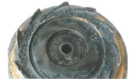
Kavitationserosion am Diffusor einer mehrstufigen Kreiselpumpe.
